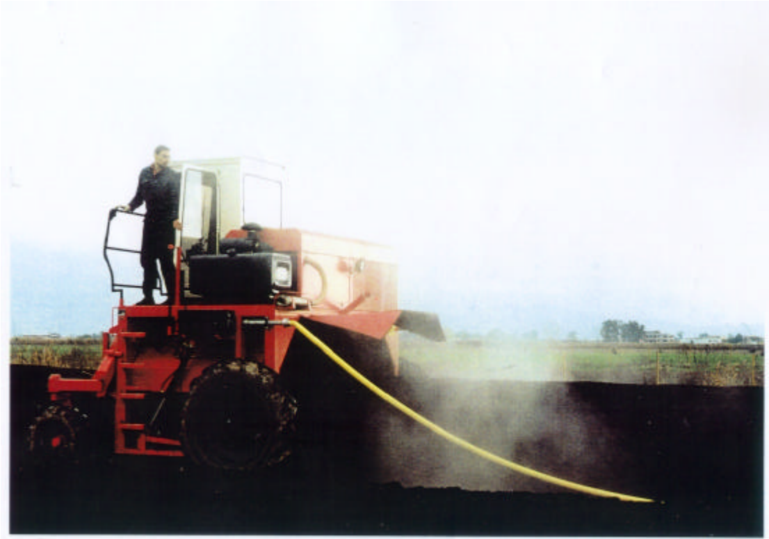
Installation de compostage du mélange grignon + margine
