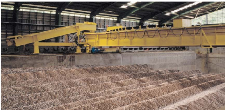
Figura 3.2.16. Método Chevcon con sistema de prehomogeneización circular para almacenamientos continuos.
