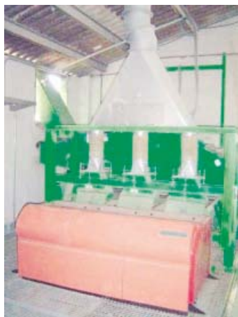
Machine permettant de trier le verre présent dans le déchet du recyclage du verre
