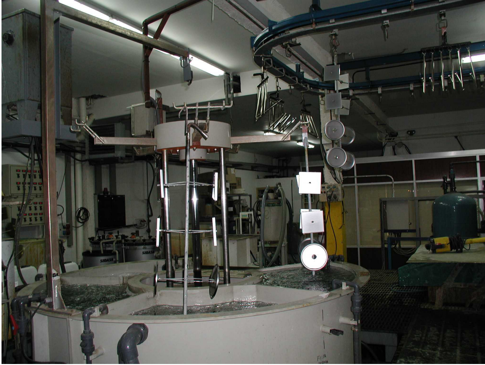
2 - Instalación automática de lavado con autómata programable.
