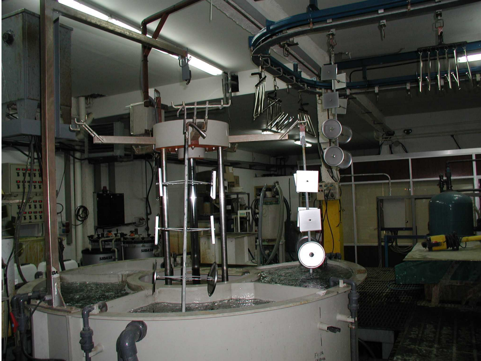
2 - Installation automatique de lavage avec automate programmable.
